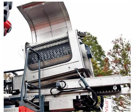
Abb. 7: Der Sortiertisch liefert bei hoher Arbeitsgeschwindigkeit bestes Erntegut.
