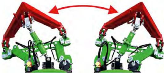
Neue hydraulische Unterlenkerverschiebung beim Deutz-Schlepper
