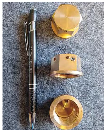
Neue Einspüldüse für eine bessere Verwirbelung *Foto: Schneider Verblasetechnik*
