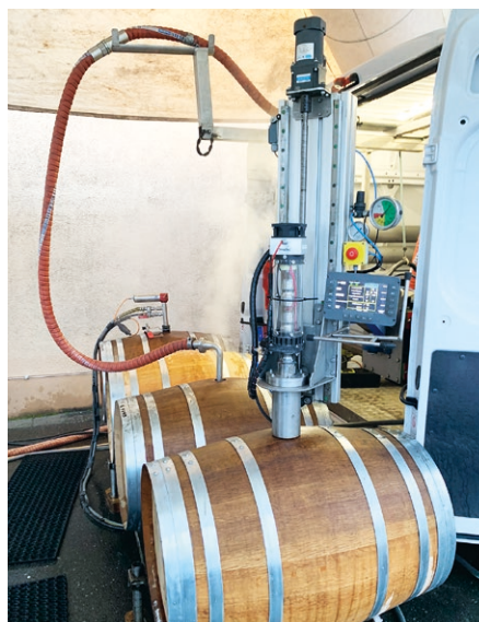
Die Dyogena-Technologie reinigt Barriques vor Ort per Ultraschall. Foto: Dyogena
